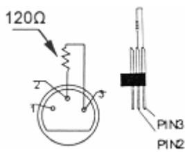
Ein DMX-Abschlusswiderstand ist empfehlenswert für Installationen, bei denen das DMX-Kabel lang ist oder in einer Umgebung mit vielem elektrischem Rauschen (z.B. Discos). Der Abschlusswiderstand verhindert Störung des digitalen Steuersignals durch elektrisches Rauschen. Der DMX-Abschlusswiderstand ist nur eine XLR-Buchse mit einem 120Ω Widerstand zwischen 2 und 3, die den XLR-Ausgang des letzten Geräts in der Kette angeschlossen wird. (Siehe Abb. Links)
