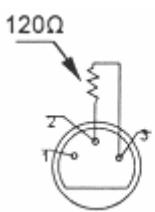
Een DMX eindweerstand is aanbevolen als de DMX-kabel vrij lang is of wordt gebruikt in een omgeving met veel elektrische ruis (bv. een discotheek). De eindweerstand voorkomt corruptie van het digitale controlesignaal door elektrische ruis. De DMX eindweerstand is niets meer dan een XLR-stekker met een weerstand van  $120\Omega$  van pin 2 naar 3. Deze XLR-stekker wordt dan aangesloten op de XLR-uitgang van het laatste toestel in de reeks. Zie de illustraties links.
