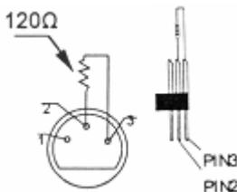
Een DMX terminator is aanbevolen als de DMX-kabel vrij lang is of wordt gebruikt in een omgeving met veel elektrische ruis (vb. een discotheek). De terminator voorkomt corruptie van het digitale controlesignaal door elektrische ruis. De DMX terminator is niets meer dan een XLR-stekker met een weerstand van 120Ω van pin 2 naar 3. Deze XLR-stekker wordt dan aangesloten op de XLR uitgang van het laatste toestel in de reeks. Zie de illustraties links.
