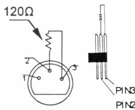
Se recomienda una terminación si el cable DMX debe cubrir una gran distancia o si se usa en un medio ambiente con mucho ruido eléctrico (ej. una discoteca). La terminación impide que el ruido eléctrico corrompa la señal de control numérico. La terminación DMX no es más que un conector XLR con una resistencia de 120Ω de polo 2 a polo 3 (véase figura a la izquierda). Este conector XLR está conectado a la salida XLR del último aparato de la serie.
