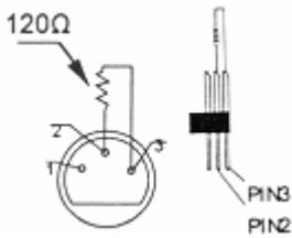
Een DMX eindweerstand is aanbevolen als de DMX-kabel vrij lang is of wordt gebruikt in een omgeving met veel elektrische ruis (bv. een discotheek). De eindweerstand voorkomt corruptie van het digitale controlesignaal door elektrische ruis. De DMX eindweerstand is niets meer dan een XLR-stekker met een weerstand van  $120\Omega$  van pin 2 naar 3. Deze XLR-stekker wordt dan aangesloten op de XLR-uitgang van het laatste toestel in de reeks. Zie de illustraties links.
