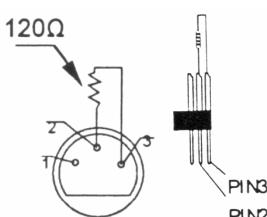
Une terminaison DMX est à recommander si le câble DMX doit couvrir une grande distance ou s'il est utilisé dans un environnement avec beaucoup de bruit électrique (ex. une discothèque). La terminaison prévient la corruption du signal de contrôle numérique par le bruit électrique. La terminaison DMX n'est rien qu'une fiche XLR avec une résistance de 120Ω de broche 2 vers broche 3 (voir illustration à gauche). Cette fiche XLR est connectée à la sortie XLR du dernier appareil de la série.
