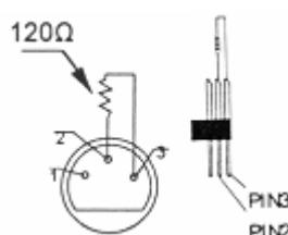
Een DMX terminator is aanbevolen als de DMX kabel vrij lang is of wordt gebruikt in een omgeving met veel elektrische ruis (vb. een discotheek). De terminator voorkomt corruptie van het digitale controlesignaal door elektrische ruis. De DMX terminator is niets meer dan een XLR plug met een weerstand van  $120\Omega$  van pin 2 naar 3. Deze XLR plug wordt dan aangesloten op de XLR uitgang van het laatste toestel in de reeks. Zie de illustraties links.
