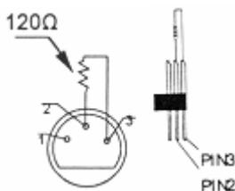
Ein DMX-Abschlusswiderstand ist empfehlenswert für Installationen, bei denen das DMX-Kabel lang ist oder in einer Umgebung mit vielem elektrischem Rauschen (z.B. Discos). Der Abschlusswiderstand verhindert Störung des digitalen Steuersignals durch elektrisches Rauschen. Der DMX-Abschlusswiderstand ist nur eine XLR-Buchse mit einem 120Ω Widerstand zwischen 2 und 3, die den XLR-Ausgang des letzten Geräts in der Kette angeschlossen wird. Siehe Abbildung.
