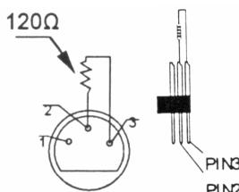
Se recomienda una terminación si el cable DMX debe cubrir una gran distancia o si se usa en un medio ambiente con mucho ruido eléctrico (ej. una discoteca). La terminación impide que el ruido eléctrico corrompa la señal de control numérico. La terminación DMX no es más que un conector XLR con una resistencia de 120Ω de polo 2 a polo 3. Este conector XLR está conectado a la salida XLR del último aparato de la serie.
