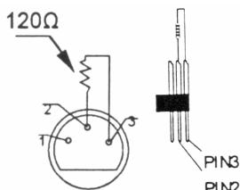
Une terminaison DMX est à recommander si le câble DMX doit couvrir une grande distance ou s'il est utilisé dans un environnement avec beaucoup de bruit électrique (ex. une discothèque). La terminaison prévient la corruption du signal de contrôle numérique par le bruit électrique. La terminaison DMX n'est rien qu'une fiche XLR avec une résistance de 120Ω de broche 2 vers broche 3 (voir illustration à gauche). Cette fiche XLR est connectée à la sortie XLR du dernier appareil de la série.
