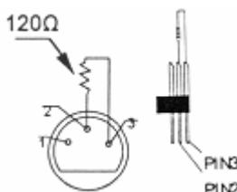
Een DMX terminator is aanbevolen als de DMX kabel vrij lang is of wordt gebruikt in een omgeving met veel elektrische ruis (bvb. een discotheek). De terminator voorkomt corruptie van het digitale controlesignaal door elektrische ruis. De DMX terminator is niets meer dan een XLR plug met een weerstand van  $120\Omega$  van pin 2 naar 3. Deze XLR plug wordt dan aangesloten op de XLR uitgang van het laatste toestel in de reeks. Zie de illustraties links.
