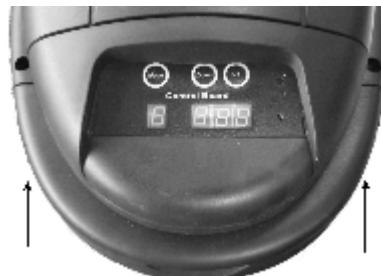
Saque la tapa inferior al desatornillar el tornillo de cada lateral con un destornillador adecuado.
