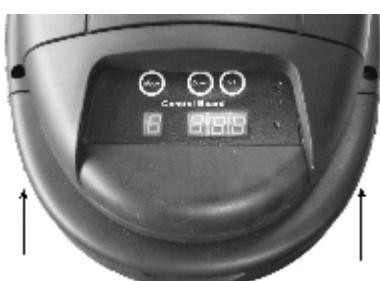
Retirer le couvercle inférieur en desserrant la vis de chaque côté à l'aide d'un tournevis approprié.
