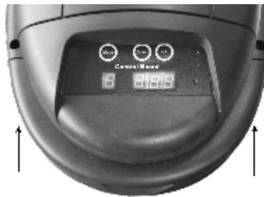
Schroef de twee schroeven aan beide zijden los met behulp van een gepaste schroevendraaier en verwijder het onderste deksel.
