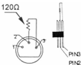
Een DMX terminator is aanbevolen als de DMX kabel vrij lang is of wordt gebruikt in een omgeving met veel elektrische ruis (bvb. een discotheek). De terminator voorkomt corruptie van het digitale controlesignaal door elektrische ruis. De DMX terminator is niets meer dan een XLR plug met een weerstand van 120Ω van pin 2 naar 3. Deze XLR plug wordt dan aangesloten op de XLR uitgang van het laatste toestel in de reeks. Zie de illustraties links.
