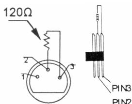
Se recomienda una terminación si el cable DMX debe cubrir una gran distancia o si se usa en un medio ambiente con mucho ruido eléctrico (ej. una discoteca). La terminación impide que el ruido eléctrico corrompa la señal de control numérico. La terminación DMX no es más que un conector XLR con una resistencia de 120Ω de polo 2 a polo 3. Este conector XLR está conectado a la salida XLR del último aparato de la serie.
