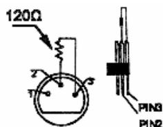
Es empfiehlt sich eine DMX-Terminierung wenn das DMX-Kabel eine große Distanz überbrücken muss oder in einer Umgebung mit vielem elektrischen Geräusch verwendet wird (z.B. Diskothek). Die Terminierung verhindert Korruption des digitalen Kontrollesignals durch elektrisches Geräusch. Die DMX-Terminierung ist nur ein XLR-Stecker mit einem Widerstand von 120Ω zwischen Pol 2 und Pol 3. Dieser XLR-Stecker wird dann in den XLR-Ausgang am letzten Gerät gesteckt.
