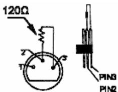
Een DMX terminator is aanbevolen als de DMX kabel vrij lang is of wordt gebruikt in een omgeving met veel elektrische ruis (bv. een discotheek). De terminator voorkomt corruptie van het digitale controlesignaal door elektrische ruis. De DMX terminator is niets meer dan een XLR plug met een weerstand van  $120\Omega$  van pin 2 naar 3. Deze XLR plug wordt dan aangesloten op de XLR uitgang van het laatste toestel in de reeks. Zie de illustraties links.
