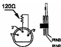
Se recomienda una terminación DMX si el cable DMX debe cubrir una gran distancia o si se usa en un medio ambiente con mucho ruido eléctrico (p.ej. una discoteca). La terminación impide que el ruido eléctrico corrompa la señal de control numérico. La terminación DMX no es más que un conector XLR con una resistencia de 120Ω de polo 2 a polo 3. Este conector XLR está conectado a la salida XLR del último aparato de la serie.
