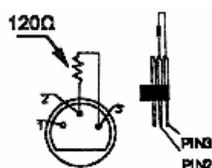
Une terminaison est à recommander si le câble DMX doit couvrir une grande distance ou s'il est utilisé dans un environnement avec beaucoup de bruit électrique (ex. un discothèque). La terminaison n'est rien qu'une fiche XLR avec une résistance de 120Ω de broche 2 vers broche 3 (voir illustration à gauche) qui prévient la corruption du signal de contrôle numérique par le bruit électrique. Cette fiche XLR est connectée à la sortie XLR du dernier appareil de la série.
