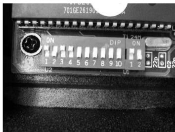
Placer les interrupteurs DIP de l'appareil maître comme illustré. Sélectionner une adresse dans la table ci-dessus.
