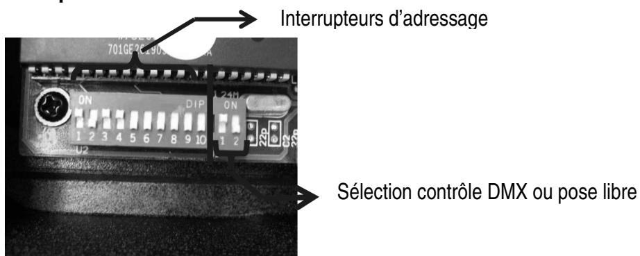
Sélectionner une adresse pour l'appareil en pose libre à l'aide des interrupteurs DIP 1 à 10. Voir table ci-dessous.
