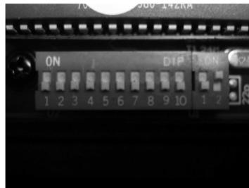
Placer les interrupteurs DIP de l'appareil esclave comme illustré. L'appareil maître réagira selon le programme maître.
