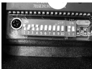
Ponga los interruptores DIP del aparato maestro (véase la figura de al lado). Seleccione una dirección de la lista (véase arriba).
