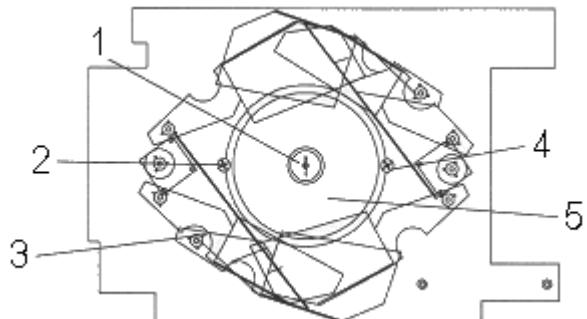
Desplace los espejos cuidadosamente a los lados para dejar libre la bombilla. Saque el soporte al desatornillar los 2 tornillos con un destornillador Phillips. Introduzca la bombilla.
