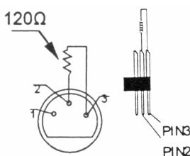
Se recomienda una terminación DMX si el cable DMX debe cubrir una gran distancia o si se usa en un medio ambiente con mucho ruido eléctrico (p.ej. una discoteca). La terminación impide que el ruido eléctrico corrompa la señal de control numérico. La terminación DMX no es más que un conector XLR con una resistencia de  $120\Omega$  de polo 2 a polo 3. Este conector XLR está conectado a la salida XLR del último aparato de la serie.
