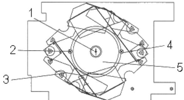
Schieben Sie die Spiegel vorsichtig zur Seite und machen Sie die Lampe sichtbar. Lockern Sie die Schrauben vorsichtig mit einem Kreuzschlitzschraubendreher und entfernen Sie den reflektierenden halter, damit die Fassung der Lampe sichtbar wird.
