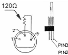
Ein DMX-Abschlusswiderstand empfehlenswert für Installationen, bei denen das DMX-Kabel lang ist oder in einer Umgebung mit vielem elektrischem Rauschen (z.B. Diskos). Der Abschlusswiderstand verhindert Störung des digitalen Steuersignals durch elektrisches Rauschen. Der DMX-Abschlusswiderstand ist nur eine XLR-Buchse mit einem  $120\Omega$  Widerstand zwischen 2 und 3, die den XLR-Ausgang des letzten Geräts in der Kette angeschlossen wird. Siehe Abbildung links.
