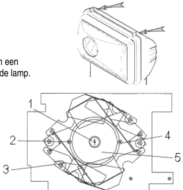
Verplaats voorzichtig de spiegels opzij en maak de lamp vrij. Maak voorzichtig de schroeven los met behulp van een kruiskopschroevendraaier en verwijder de reflecterende houder zodat de fitting van de lamp vrijkomt.
