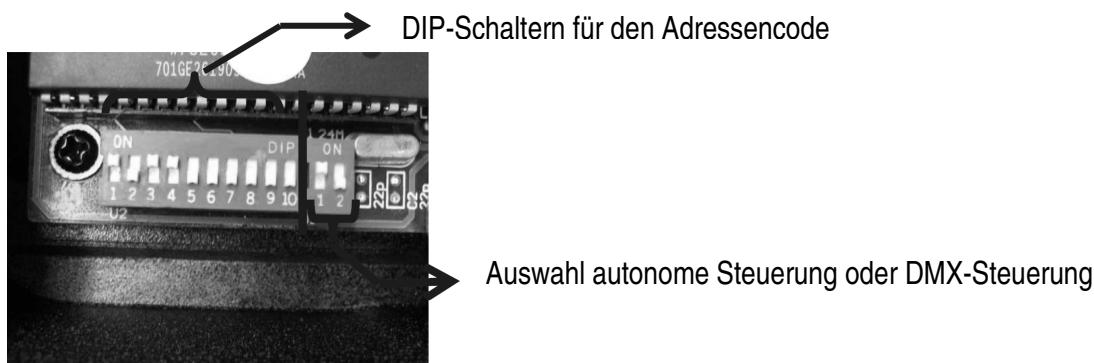
Wählen Sie mit den DIP-Schaltern 1 bis 10 eine Adresse für die autonome Anwendung aus. (siehe Liste unten)
