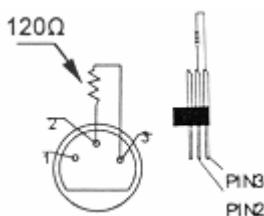
Een DMX terminator is aanbevolen als de DMX-kabel vrij lang is of wordt gebruikt in een omgeving met veel elektrische ruis (vb. een discotheek). De terminator voorkomt corruptie van het digitale controlesignaal door elektrische ruis. De DMX terminator is niets meer dan een XLR-stekker met een weerstand van  $120\Omega$  van pin 2 naar 3. Deze XLR-stekker wordt dan aangesloten op de XLR-uitgang van het laatste toestel in de reeks. Zie de illustraties links.
