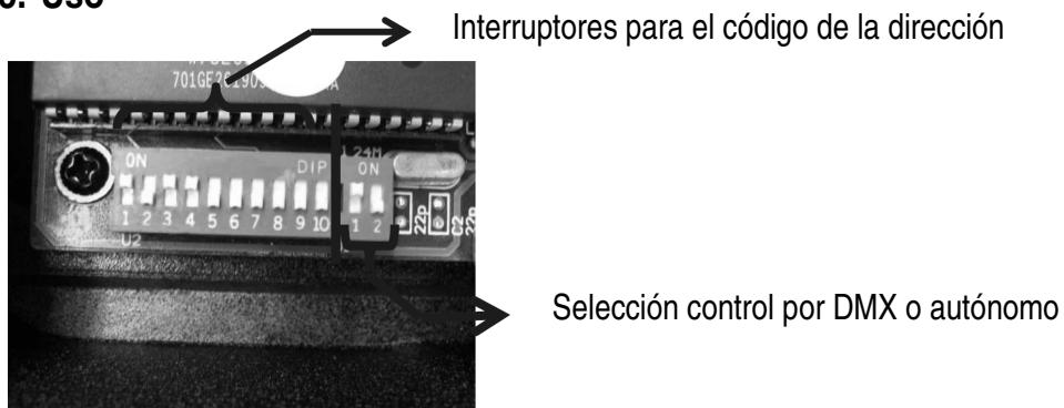
Para el uso autónomo, seleccione una dirección con los interruptores DIP de 1 a 10. Véase la lista a continuación.
