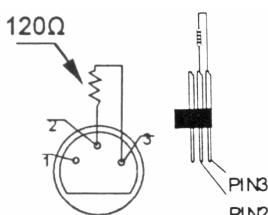
Een DMX terminator is aanbevolen als de DMX kabel vrij lang is of wordt gebruikt in een omgeving met veel elektrische ruis (bv. een discotheek). De terminator voorkomt corruptie van het digitale controlesignaal door elektrische ruis. De DMX terminator is niets meer dan een XLR plug met een weerstand van 120Ω van pin 2 naar 3. Deze XLR plug wordt dan aangesloten op de XLR uitgang van het laatste toestel in de reeks. Zie de illustraties links.
