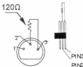
Une terminaison est à recommander si le câble DMX doit couvrir une grande distance ou s'il est utilisé dans un environnement avec beaucoup de bruit électrique (ex. un discothèque). La terminaison n'est rien qu'une fiche XLR avec une résistance de 120Ω de broche 2 vers broche 3 (voir illustration à gauche) qui prévient la corruption du signal de contrôle numérique par le bruit électrique. Cette fiche XLR est connectée à la sortie XLR du dernier appareil de la série.
