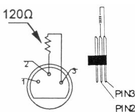
Ein DMX-Abschlusswiderstand ist empfehlenswert für Installationen, bei denen das DMX-Kabel lang ist oder in einer Umgebung mit vielem elektrischem Rauschen (z.B. Discos). Der Abschlusswiderstand verhindert Störung des digitalen Steuersignals durch elektrisches Rauschen. Der DMX-Abschlusswiderstand ist nur eine XLR-Buchse mit einem 120Ω Widerstand zwischen 2 und 3, die den XLR-Ausgang des letzten Gerätes in der Kette angeschlossen wird.
