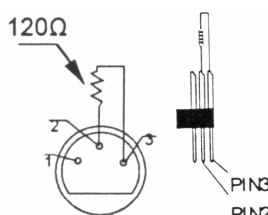
Se recomienda una terminación si el cable DMX debe cubrir una gran distancia o si se usa en un medio ambiente con mucho ruido eléctrico (p.ej. una discoteca). La terminación impide que el ruido eléctrico corrompa la señal de control digital. La terminación DMX no es más que un conector XLR con una resistencia de  $120\Omega$  de polo 2 a polo 3 (véase figura a la izquierda). Este conector XLR está conectado a la salida XLR del último aparato de la serie.
