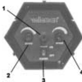
Sluit het toestel aan op het lichtnet via de stekker. Lichteffecten worden bij voorkeur niet aangesloten op een dimmerpack. Plaats de voedingsschakelaar (3) in de ON-stand. Regel de muziekgevoeligheid met draairegeling (2) en stel de snelheid in met draairegeling (4). Via de ingebouwde microfoon produceert het toestel nu kleurrijke lichtflitsen op het ritme van de muziek.
