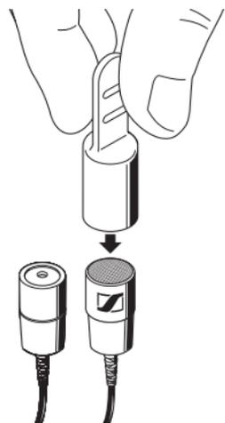
Si vous désirez fixer le MKE platinum-C sur la tête et le dissimuler par du maquillage, veuillez protéger le microphone avec la protection maquillage. Cette protection est mise sur le micro (avec ou sans capuchon) et évite que du maquillage puisse entrer dans la grille du microphone. Enlever la protection juste avant l'entrée en scène.
