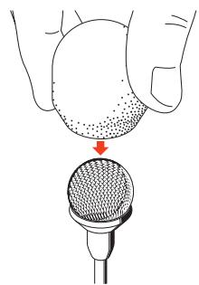
Potete ottenere un ulteriore riduzione dei rumori di soffio e vento di altri 10 dB utilizzando il cappuccio antivento di garza MZW02.
