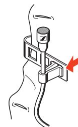
Wanneer het materiaal van uw kleding dit toelaat, kunt u de microfoon met de speld MZS 2 bevestigen. Deze bevestiging is veel steviger en is bovendien handig wanneer uw kleding geen kraag of omslagen heeft waaraan de klem MZQ 2 stevig kan worden bevestigd.
