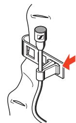
Wenn es der Kleiderstoff erlaubt, können Sie das Mikrofon mit der Anstecknadel MZS 2 befestigen. Diese Befestigung ist mechanisch stark belastbar. Sie bietet sich außerdem an, wenn an der Kleidung keine Aufschläge oder Kanten sind, an denen die Klammer MZQ.2 Halt findet.
