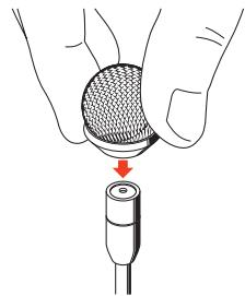
Mettre d'abord la bonnette MZW 2, qui permet de réduire les bruits de vent et les plosives de 20 dB max.
