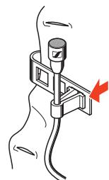
Se il tessuto del Vostro vestito lo permette potete fissare il microfono con lo spillo per appuntare MZS 2. Questo fissaggio è molto resistente alle sollecitazioni meccaniche. E' indicato soprattutto quando il vestito non ha risvolti o bordi ai quali si può fissare la clip MZQ.2.
