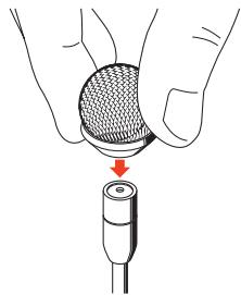
Gebruik in eerste instantie de windbeschermkap MZW 2. Ademhalings- en windgeruis wordt maximaal ca. 20 dB verminderd.
