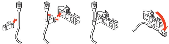
Für dünne Stoffe (z.B. Seide) verwenden Sie bitte die äußere Halterung, dort ist die Andruckkraft der Klammer am höchsten.
