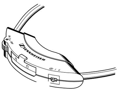
En la cara inferior del receptor de mentonera HDI 302 encontrará Vd. un conmutador de canales con el cual puede Vd. elegir entre las siguientes opciones:
