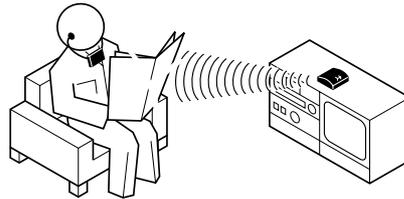
Infrarotes Licht breitet sich in gleicher Weise aus wie das Licht einer Glühlampe. Verdecken Sie nicht den Lichtweg zwischen Sender und Empfänger und bleiben Sie in dem Raum, in dem die Übertragung stattfindet!
