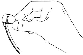
Om de kinbeugelontvanger te reinigen hoeft u deze alleen maar met een vochtige doek af te nemen. Gebruik geen oplosmiddelen.
