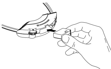
Inserite l'accumulatore BA 151 nell'apposito vano del ricevitore.
