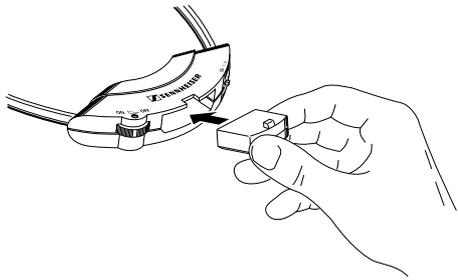
Stecken Sie den Akku BA 151 in den Schacht im Empfänger.
