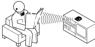
La luz infrarroja se difunde de manera similar a la luz de una bombilla. Evite cubrir el largo de camino óptico entre transmisores y receptores y permanezca en el recinto en el cual tiene lugar la transmisión.
